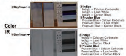
図2 青色対照試料の可視光撮影画像及び赤外線撮影画像
