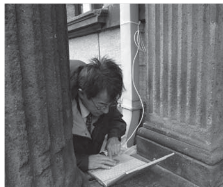
壁面部分の温湿度データ回収の様子
