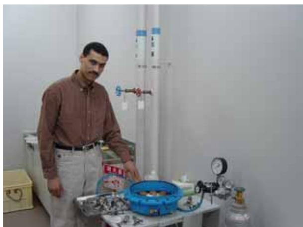
墳丘土の加圧板法による水分特性測定の様子
