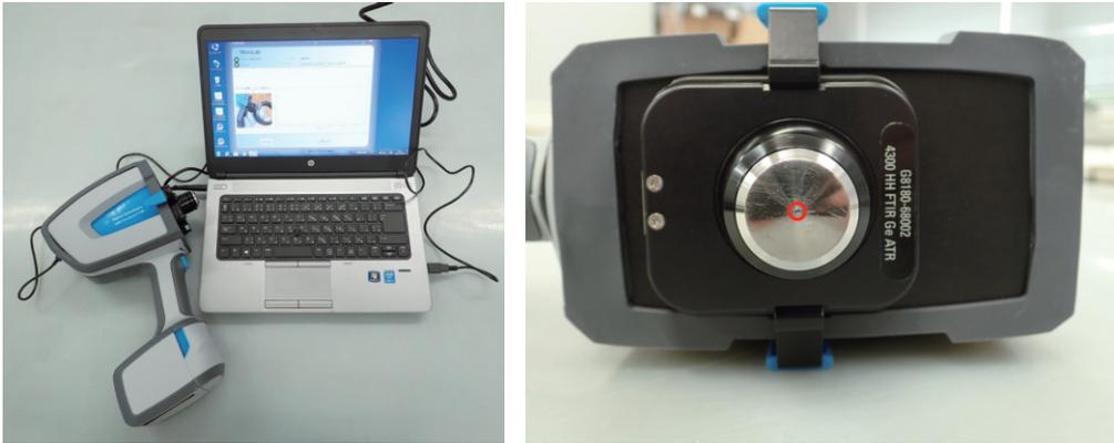
写真2 ハンドヘルド4300FT-IRを使用した測定の様子(写真左)その測定部(写真右)
