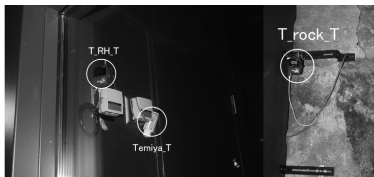
図3 カプセル内の観測機器設置状況 (左) 温湿度, (右) 壁面表面温度
