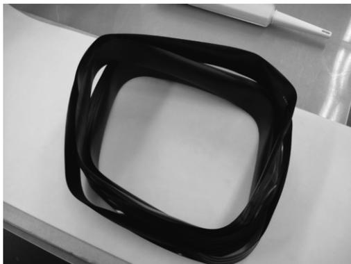
図2 変形したフィルモン音帯
