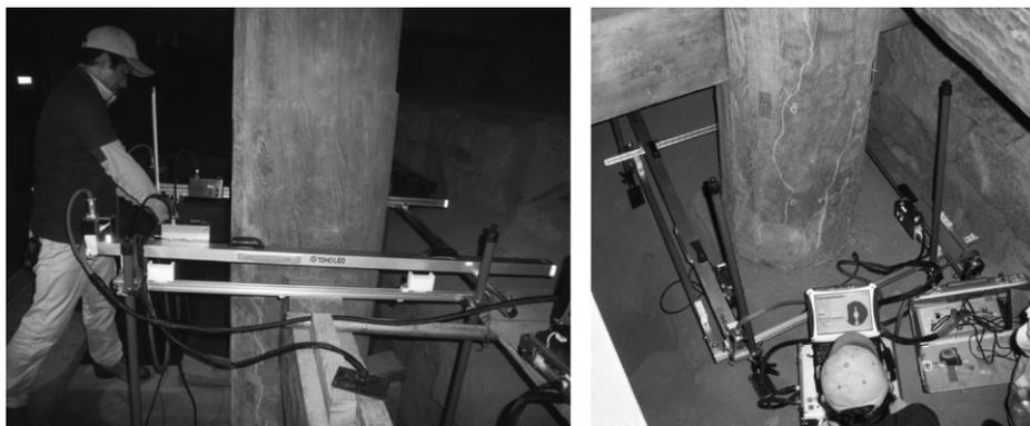
図1 ガンマ線走査装置の設置状況
