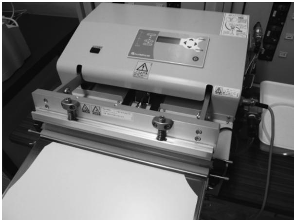
使用した富士インパルス株式会社製 マイコン制御 卓上型ノズル式脱気シーラー V-402
