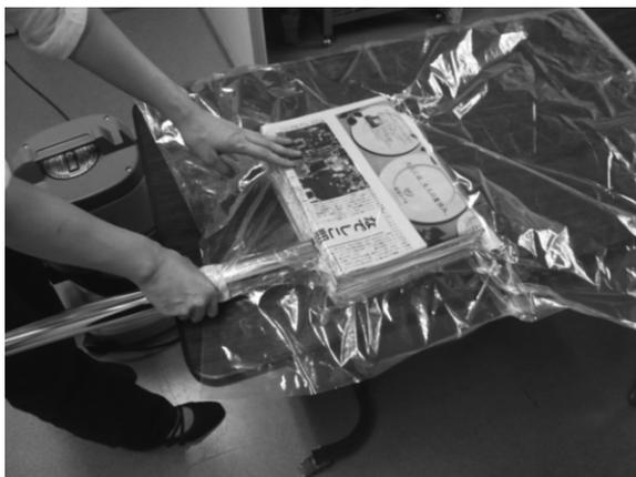
⑨吸引により袋が内容物に張り付いたら、掃除機のスイッチを切らずにノズルを引き抜く
