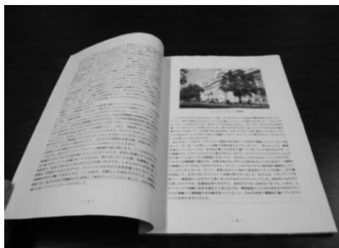
c. 純水に水浸後, スクウェルチ・ドライイング法を実施した試料 (左表紙, 右見開き)
