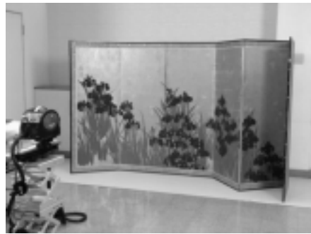
図1 燕子花図屏風の蛍光X線分析の様子
