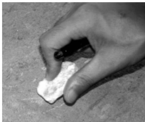
図4 モース硬度測定風景
