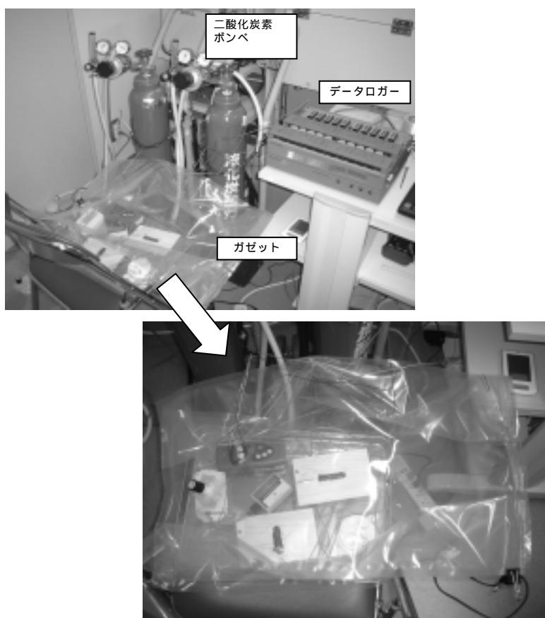
写真1 高濃度二酸化炭素中のひずみを測定するためのセットアップ
