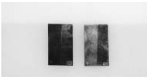
写真4 I.J (色上げに用いた液体の種類：ヨウ素のみ)
