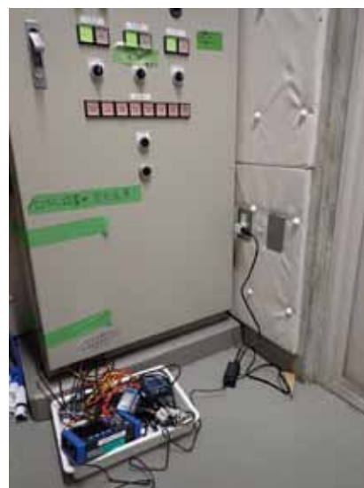
写真1 収蔵庫における消費電力測定の様子
