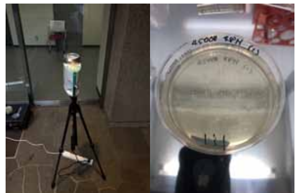
浮遊菌の捕集風景と、捕集した浮遊菌の培養状況
