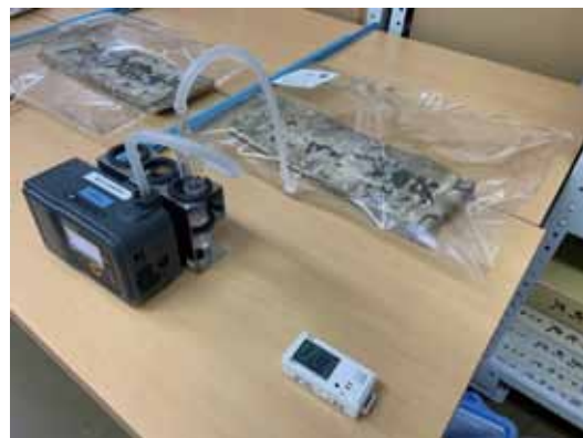
被災資料からの揮発成分調査
