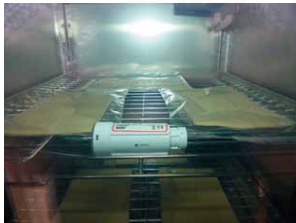
カビを死滅させる湿熱条件が紙の物理化学性に与える影響評価試験の様子
