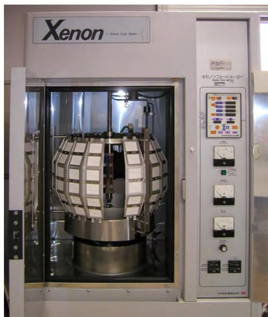
露光試験に用いるキセノンフェードメータの例
