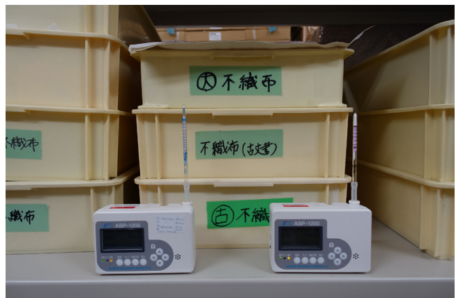
北川式検知管によるアンモニア、有機酸濃度の測定風景
