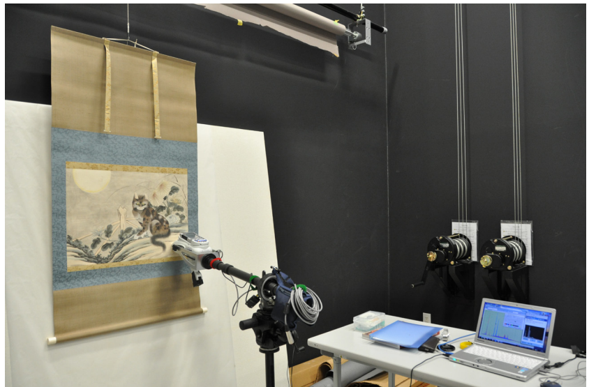
可搬型蛍光X線分析装置による絵画の彩色材料調査
