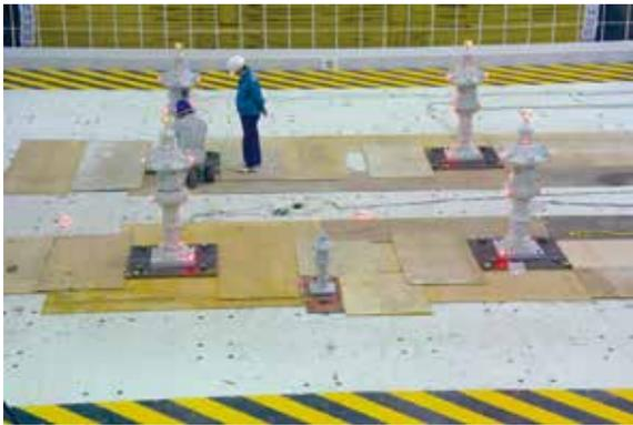
大型一軸振動台を用いた実物大石灯籠の振動実験
