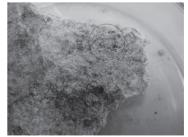
印をつけた場所に筆で酵 写真2 塗布と吸着作業を繰り返 して、ゲルを除去した
