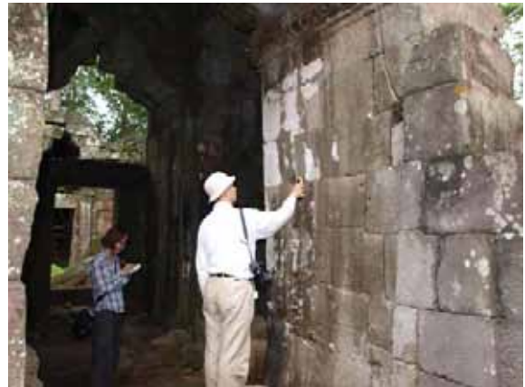
タ・ネイ遺跡での石材の帯磁率の測定 (カンボジア)
