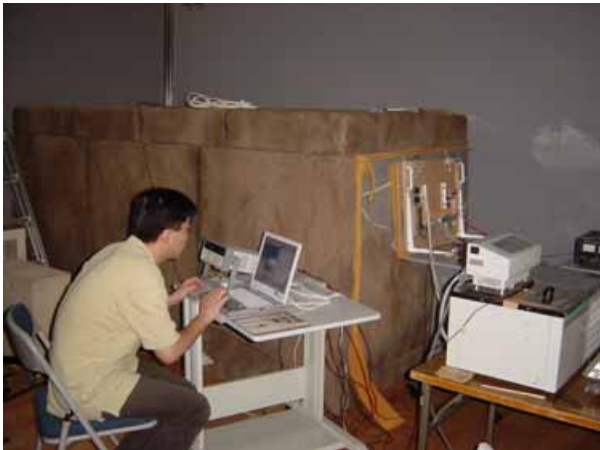
実規模石室模型を用いた石室内環境制御実験
