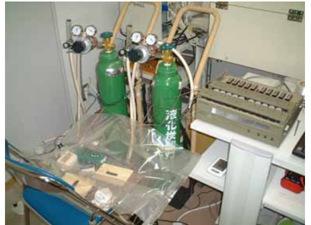
新たな殺虫処理法についての検討 二酸化炭素処理の際のひずみの測定
