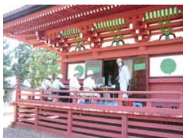
最勝院五重塔の振動測定調査
