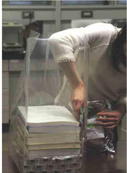
低酸素濃度法による殺虫処理の様子
