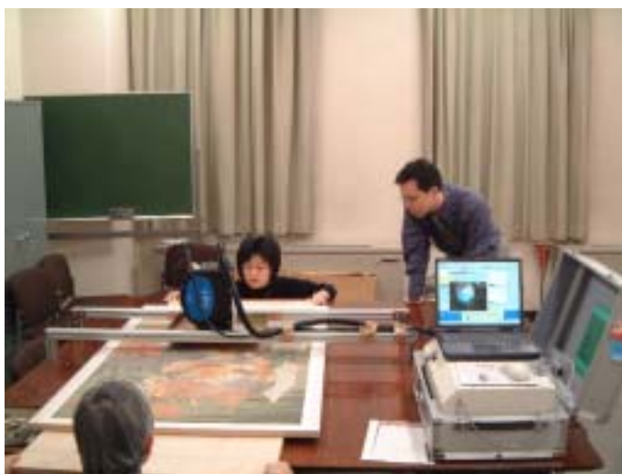
ポータブル蛍光X線分析装置による絵画の彩色材料調査
