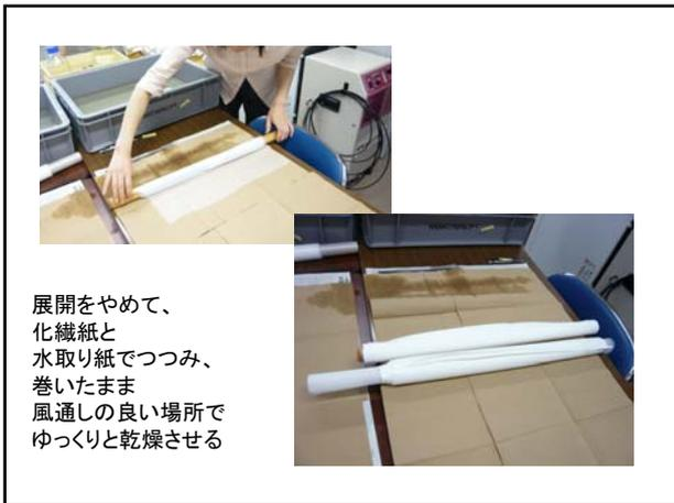
津波で被災した掛け軸の応急処置の例 2011.5月
