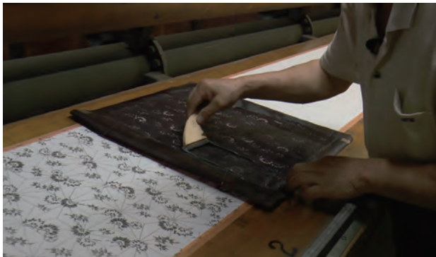
図5 型紙による型付の作業（東京文化財研究所撮影）
