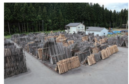
製材後、3～5年程度雨風に晒してシブを抜く（「会津桐タンス株式会社」）
