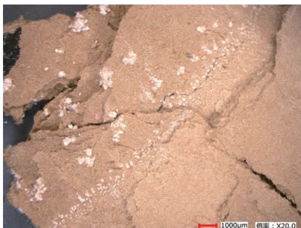
海水による被災後の塩類析出 Salt deposition after damage by sea water
