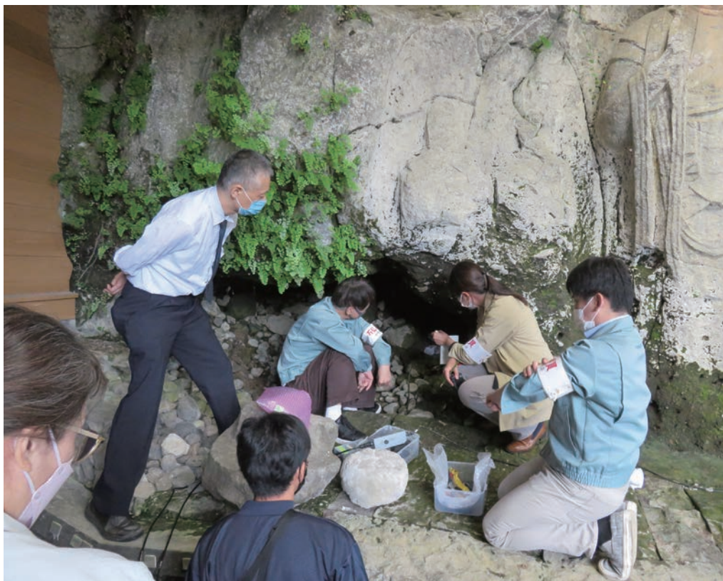
岩壁の水分量を計測するための含水率計の設置
