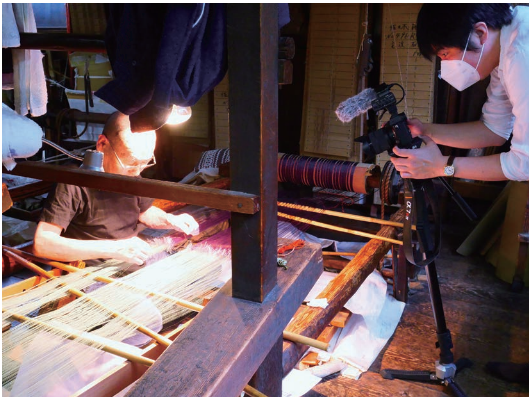
機にける経糸を継ぎ調整する（経継ぎ）
