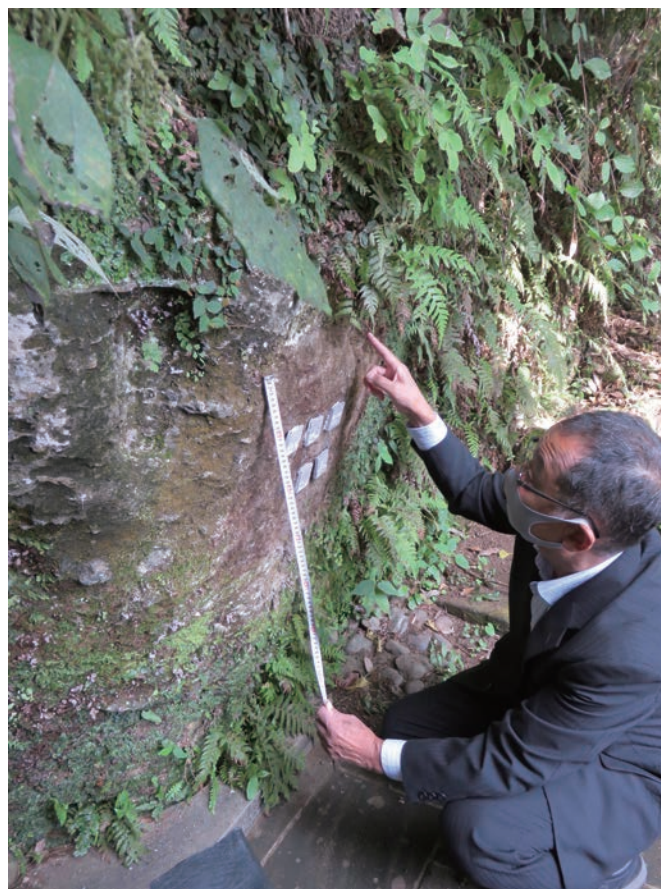
曝露試験用の接着サンプルの設置
