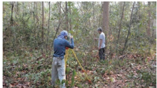
トータルステーションを用いた地形測量 Topographical survey using a total station
