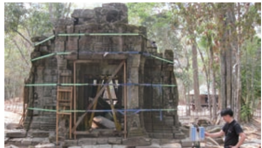
レーザースキャナーを用いた東門の測量 Survey of the east gate using a laser scanner
