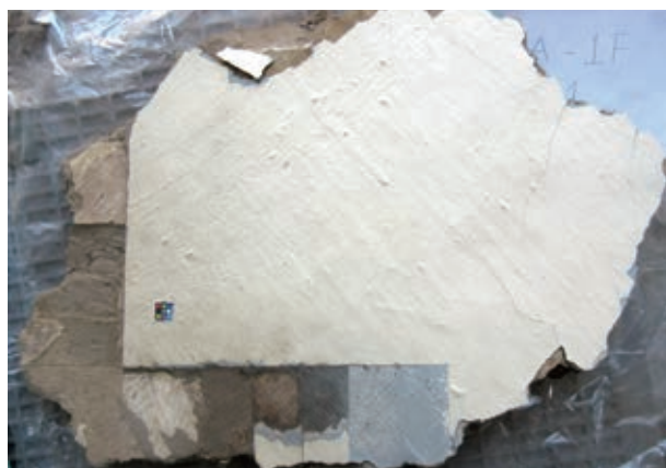
階段状に各時代の仕上げ層を削り出した試料 Sample with the finishing layer from each period carved out in tiers
