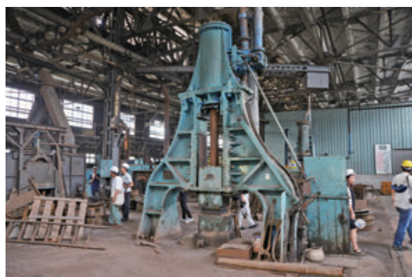
現地調査の様子。台北機廠鉄道修理工場内の鍛冶工場に残された台工141号スチームハンマー（東洋鐵工所製作、昭和9（1934）年購入）
