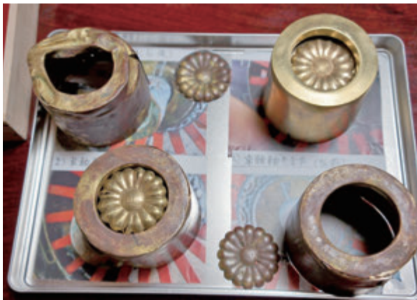
修理のために取り外された曳山の金具(車軸軸先金具) Metalwork removed from the float for restoration (shaft-point metalwork).
