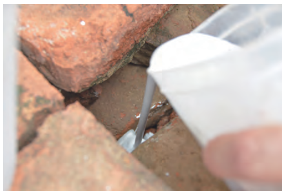
水硬性石灰による充填実験 An experiment on filling using hydraulic lime
