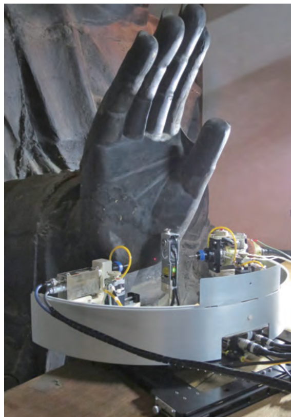
可搬型X線回折分析装置を用いた飛鳥大仏の材質調査
