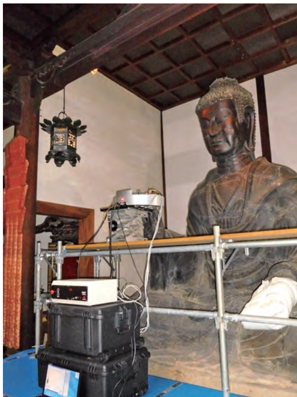
可搬型X線回折分析装置を用いた飛鳥大仏の材質調査
