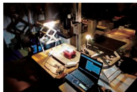
ハイパースペクトルカメラを用いた調査 Investigation using a hyperspectral camera
