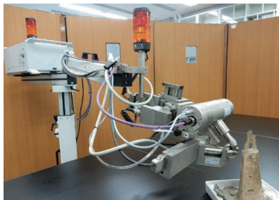
大型資料分析用の蛍光X線分析装置 X-ray fluorescence spectrometer for large cultural objects
