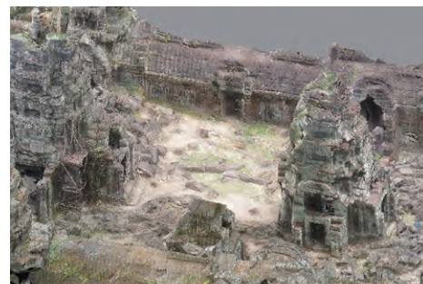
カンボジア・タネイ寺院のSfM手法による3次元写真測量データ Three dimensional photogrammetry data of Ta Nei temple, Cambodia by SfM technique
