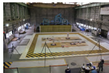
石灯籠の振動実験 Vibration test of stone lanterns
