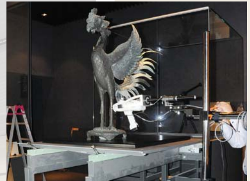
ハンドヘルド蛍光X線分析装置を用いた金属文化財のその場分析 On-site analysis of a metal object by a handheld X-ray fluorescence spectrometer
