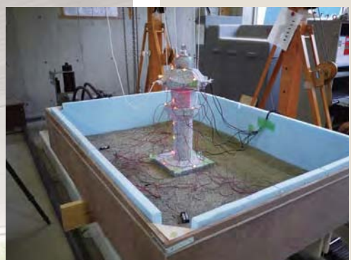
石造文化財(石灯籠)の地震対策に関する実験 Vibration test of stone monuments (stone lantern)
