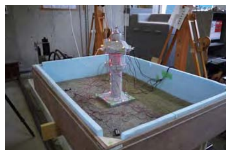
石造文化財(石灯笼)の地震対策に関する実験 Vibration test of stone monuments (stone lantern)
