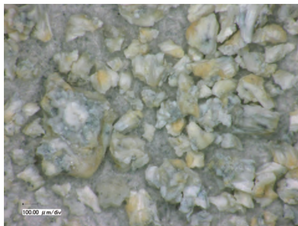
鉛に生じた腐食生成物の顕微鏡観察
