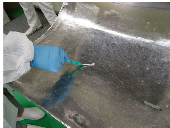
ルシパックを用いた、ふき取り検査の様子
