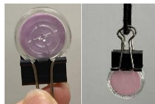
クリップ等はガス透過孔を塞がない ようにセットします
