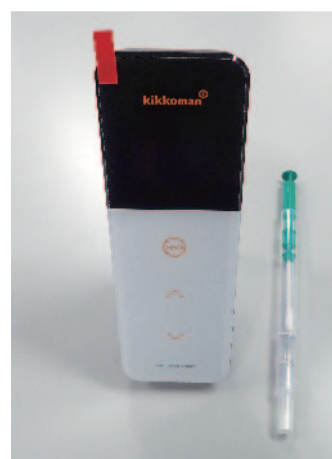
図6 ATP ふき取り検査 (A3法) 用の検査試薬 (ルシパック A3 Surface (乾燥綿棒)) とポータブル式ルミノメーター (ルミテスター Smart)
