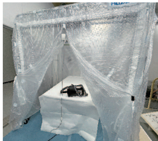
図2 陰圧ブース。養生完了後の状態
