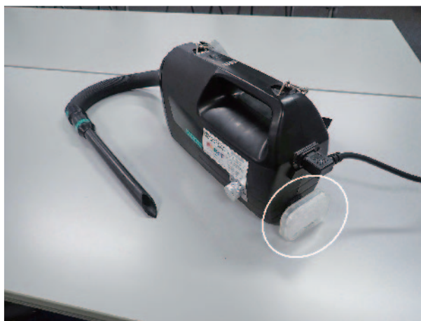
図 4 HEPA フィルター付き小型掃除機（小型ミュージアムクリーナー）。排気エアフィルター（白丸）を装着して使用する
