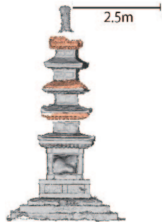
図12 図11をベースに一部部材を今回計測した金沢市内の石材に置き換えた図。二層笠下側石材を成巽閣石材に、三層笠石を兼六園石材に、五層笠石を大樋美術館石材に置き換えて暗色で表示
