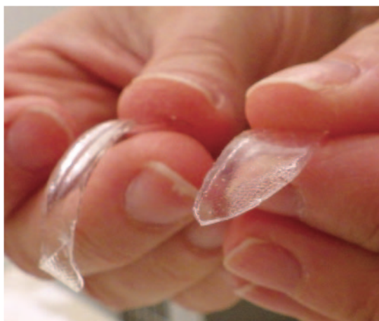
図1 ジェランガム4% Caなし (左) Ca添加 (右) : Caなしの方が柔らかく、Ca添加はアガーに似た硬さ
