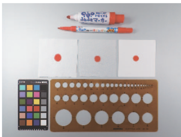
図2 テストサンプル作製に使用した材料 : 上から赤色水性ペン太型・細型、中段左から木綿布・絹布・ろ紙、最下段は円定規
