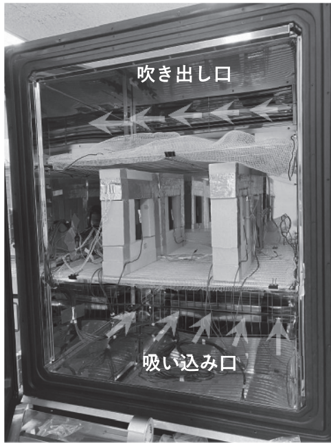
4-a 恒温恒湿槽内に試験体を設置した様子
