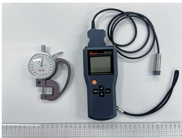
図1 電磁式膜厚計（右）とダイヤルゲージ式厚さ計（左）
