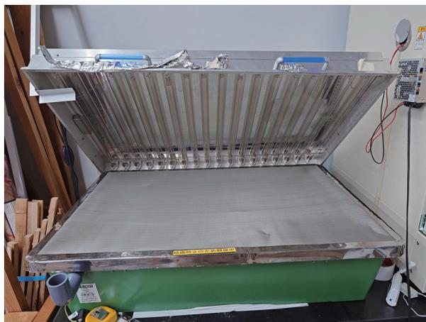
図2 紫外線照射装置
