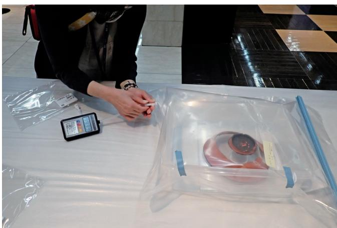
図4 遺物を封入したテドラーバッグ内の空気のサンプリングの例
