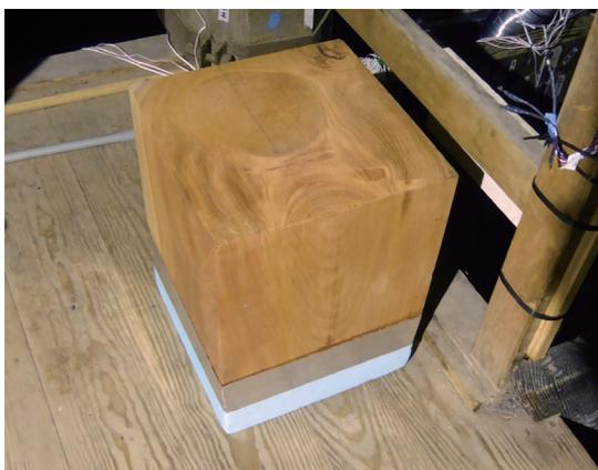
図2 中禅寺鐘楼内部に設置した殺虫効果判定試験材
