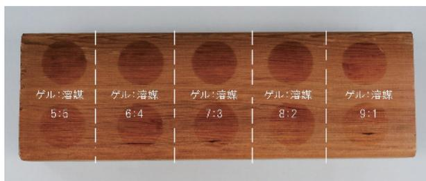
図3 試験体の例(油B)
