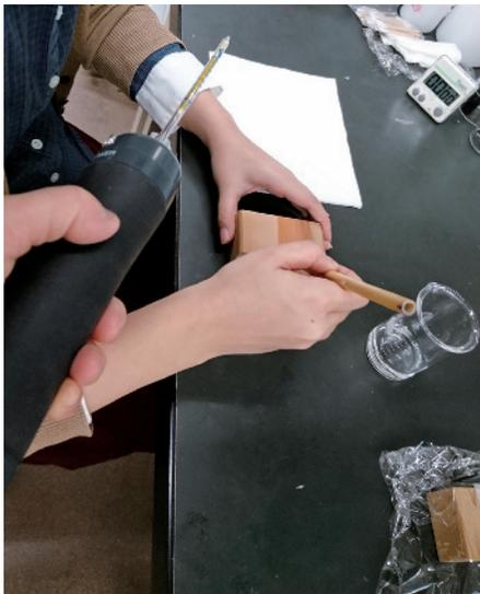
図8 筆処置 検知管を使用して測定
